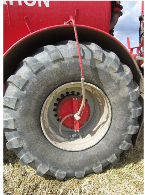
Billede 7. Dæktryksreguleringssystem på bagaksel på forvogn.
